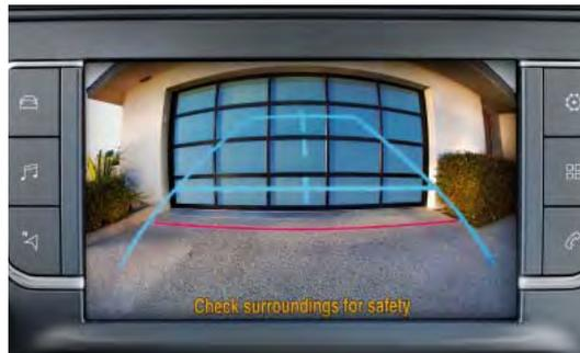
Cámara de visión trasera con guías de aparcamiento. La cámara de visión trasera de PROACE VERSO ofrece una imagen de gran nitidez, para que puedas aparcar con gran facilidad.
