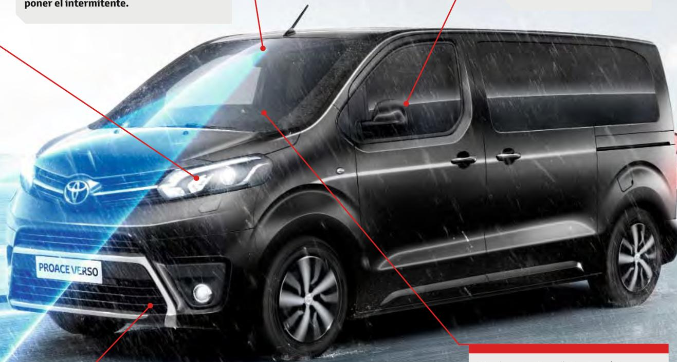
El sistema de seguridad pre-colisión con detector de peatones, si detecta posibilidad de colisión, activa unos avisos sonoros y visuales, así como la asistencia de frenado. Si el conductor no reacciona a tiempo, los frenos se activan automáticamente para evitar o mitigar la colisión.
