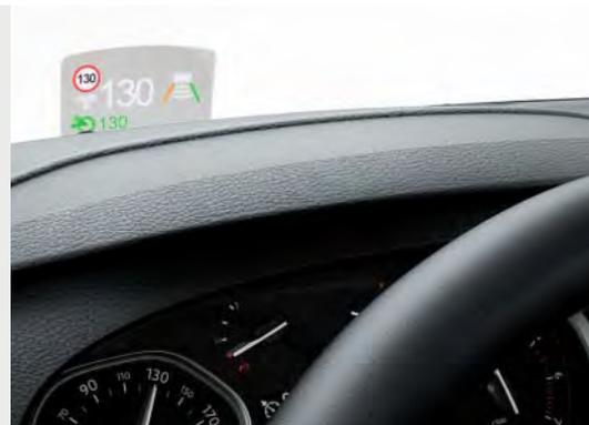
El avanzado Head Up Display proyecta una serie de información en una pantalla delante del parabrisas – como la velocidad actual, las instrucciones de navegación y las alertas de conducción activas- en la línea de la visión del conductor.
